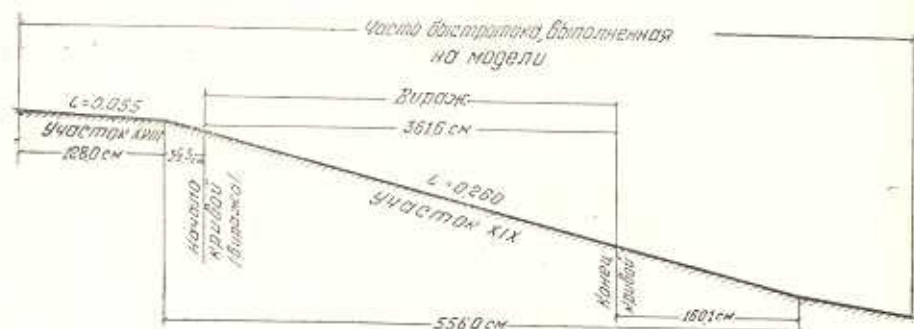
Фиг. 3. Продольный профиль по оси быстротока в районе расположения выража (на схеме указаны модельные размеры)
